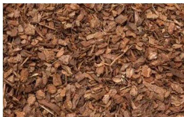
halfverharding noordelijke plein: houtsnippers
